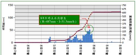
參考雨量站: 屈尺(C0A580) 土石流警戒基準值:500mm
